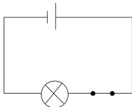
Rappel : sur ce schéma, l'interrupteur est fermé. Il y a du courant électrique dans le circuit. La lampe brille.
