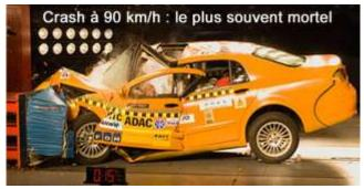
À la vitesse du crash-test (64 km/h), les occupants ont une possibilité de survie et plus la vitesse d'un choc est proche de 64 km/h, plus la violence du choc (décélération) subi par les occupants est amoindrie : à 90 km/h par exemple on est éloigné de 26 km/h par rapport à 64 km/h alors qu'à 80 km/h on en est éloigné de 16 km/h : soit 62%. Le cumul de ce 62 % et de la baisse précédente de l'énergie cinétique (79%) donne un amoindrissement total de 0,79 x 0,62 = 0,49.
